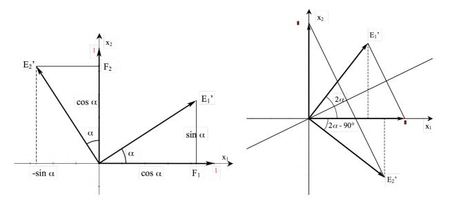
Spiegelung an einer Geraden, die mit der  $x_1$ -Achse den Winkel  $\alpha$  einschließt
