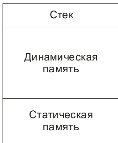
Рис 13.1. Структура памяти, доступной программе
